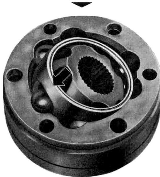
9 - Gelenk auf Funktion prüfen. Das Gleichlaufgelenk ist richtig zusammengebaut, wenn sich die Kugelnabe von Hand über den gesamten Längenausgleich hin- und herschieben läßt.
