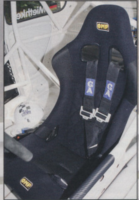
OMP-Schalensitz und 6-Punkt-Gurt sorgen für guten Halt im Renn-Käfer
