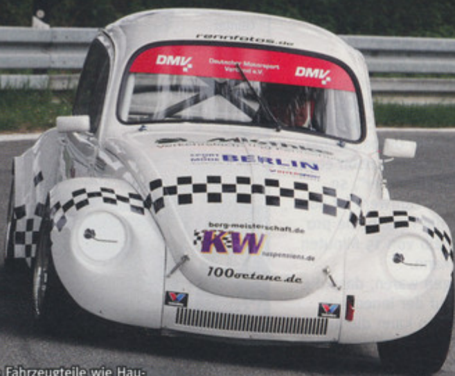
Viele Fahrzeugteile wie Hauben, Kotflügel oder Türen bestehen aus Kohlefaser
