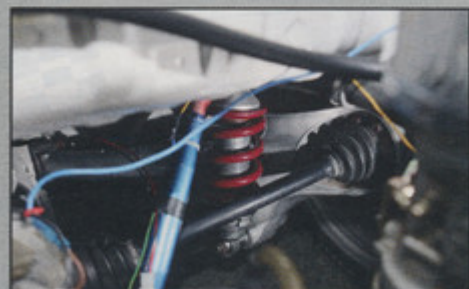
Porsche-Aluschräglenker an der Hinterachse
