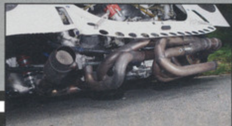
Der handgefertigte Fächerkrümmer gleicht einem abstrakten Kunstwerk
