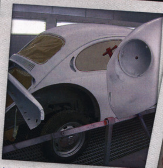
DER WEISSE RIESE: ALLE ANBAUTEILE WURDEN SEPARAT LACKIERT, DIE RADKÄSTEN MIT HAMMERIT VERSIEGELT
