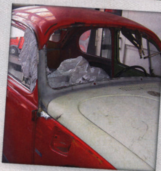
EIN PASSENDES DACH WAR BEIM KAUF DABEI, DEN UNTEREN SCHEIBENRAHMEN SPENDETE NACH LÄNGER SUCHE EIN SCHROTT-1302
