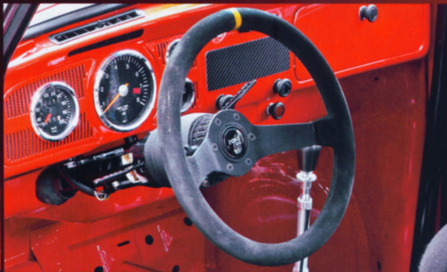
Oben: Porsche- und VDO-Instrumente nebst geschüsseltem Raid mit Quick Out-Adapter Unten links: Geschlitzter Kamei-Spoiler, Luftleitbleche für den Ölkühler und Girling Alu-Sättel auf Kerscher-Scheiben Unten rechts: Die Batterie ist in einem Carbon-Gehäuse verschwunden
