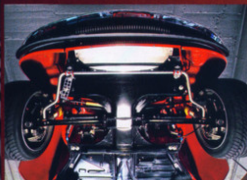
Rechts: Selbst die Blinkergehäuse sind im Zuge des Leichtbaus sorgsam ausgeschliffen Unten: Der 1302 hat BBS Rennsport-Felgen in acht und 8,5 mal 16 Zoll mit 215/40er Reifen vorn und 225/40er Reifen hinten zu bieten
