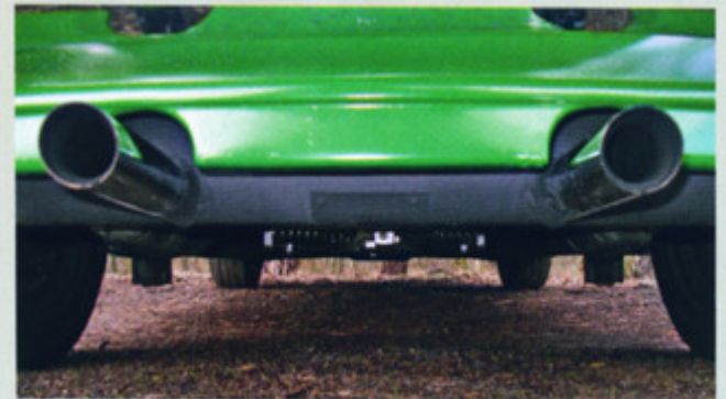
Nachgerüstet: Der Sebring-Auspuff verleiht dem Null-Zwo einen kernigeren Sound.
