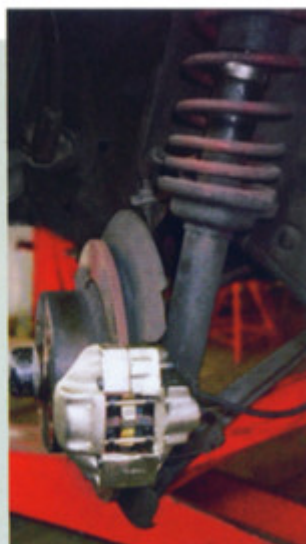
Genervt: Bernd Köhler beseitigte das Quietschen der alten Bremszangen durch den Einbau von ATE-Bremssätteln.
