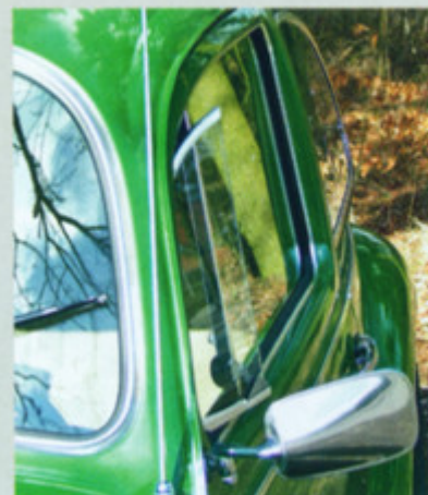
So lässt es sich aushalten: Die vorne einströmende und durch die hinteren Ausstellfenster austretende Luft erzeugt ein angenehmes Klima.
