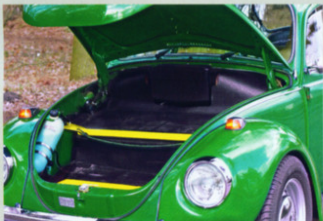
Hightech unter der Haube: Die elektrische Pumpe zur Förderung ist unter dem Vorratsbehälter der Waschanlagenflüssigkeit untergebracht. Das traditionell halb stehende Ersatzrad ist liegend unter der Kofferraumverkleidung versteckt.
