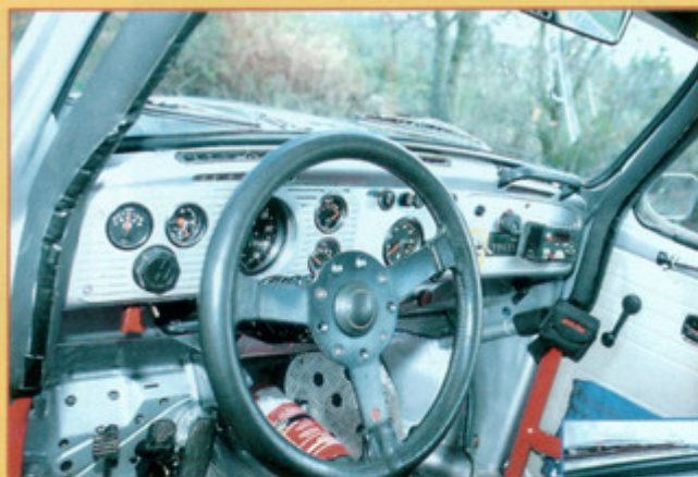
Beide Arbeitsplätze im Rallye-Käfer sind mit zahlreichen Zusatzinstrumenten bestückt. Wichtigste Hilfsmittel des Befahrers sind der Tripmaster von Datec (kleines Bild) und eine Stoppuhr.
