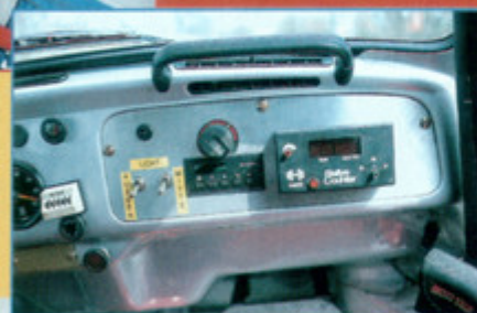
Beide Arbeitsplätze im Rallye-Käfer sind mit zahlreichen Zusatzinstrumenten bestückt. Wichtigste Hilfsmittel des Befahrers sind der Tripmaster von Datec (kleines Bild) und eine Stoppuhr.
