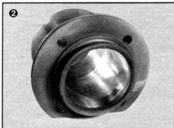
**2** Bei der Demontage des Käfer-Motors kam als Folge eines abgerissenen Ventils ein völlig zerstörter Kolben zum Vorschein (1). Nichts mit dem Ventilschaden hatten dagegen Risse zu tun, die sich an allen vier Kerzenlöchern zeigten (3). Die Zylinder (2) wiesen ebenso wie die Nocken sehr gute Laufbilder und kaum meßbaren Verschleiß auf. Während der Ventil-
