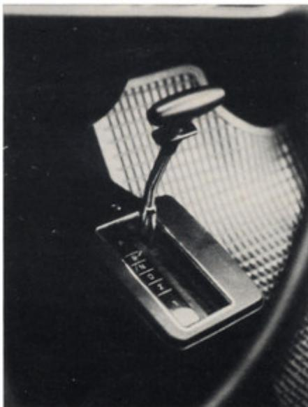
Mit diesem Wählhebel wird die lebendige Opel-Automatik bedient
