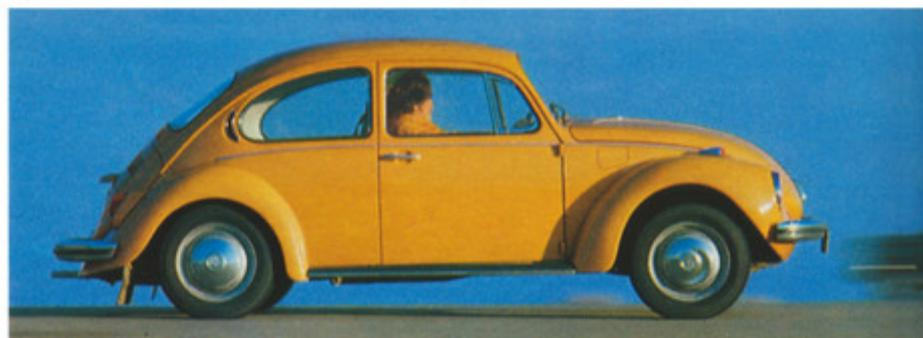
VW 1302 LS: 1584 ccm, 50 PS, Halbautomatik mit drei Gängen, Spitze 128 km/h
