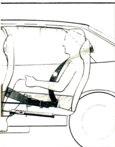
Knie- und Schultergurte mit automatischer Spannvorrichtung werden beim Aufprall durch zwei Druckzylinder mit einer ganz dezenten Sprengladung allen Insassen zwangsweise angelegt.
