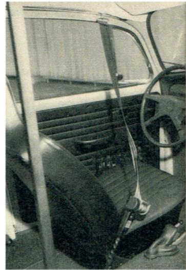
*VW entwickelte neue Gurtsysteme: Als Gegner des Air-bags (rechts) sind aufgeboten: Dreipunktgurte mit Zündkontakt, passive Gurte und die Spannautomatik für Knie- und Schultergurte.*
