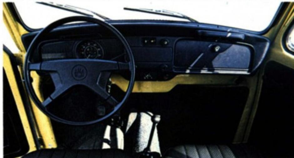
Armaturen vor dem Sicherheitslenkrad mit Pralltopf, ein Ablagefach im 72er Käfer
