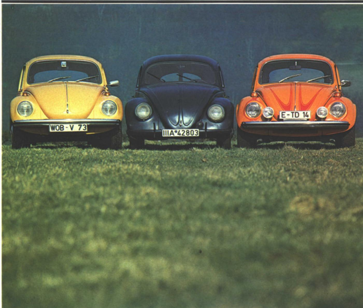
Drei Generationen im Test: 72er Käfer mit 50, KdF-Wagen mit 25, Super-Käfer mit 105 PS. Der Endstand der Entwicklung ist noch fern
