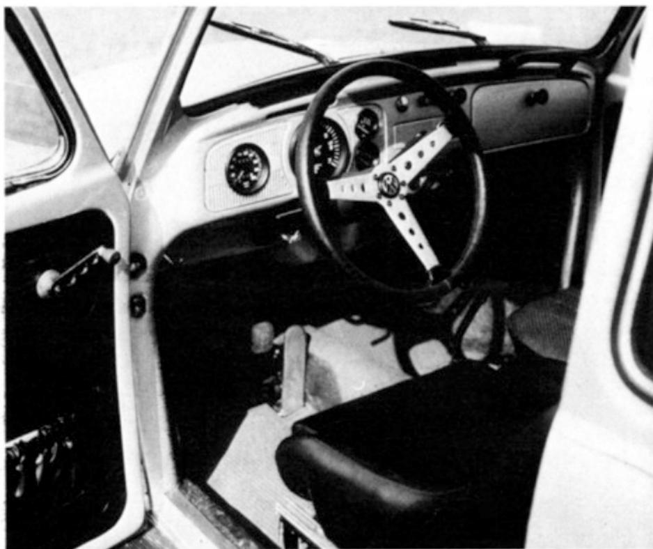
Das Cockpit des Renn-Käfers mit Schalensitz, Sportlenkrad und Zusatzinstrumenten. Im Blickpunkt des Fahrers liegt der große Drehzahlmesser aus dem VW-Porsche
