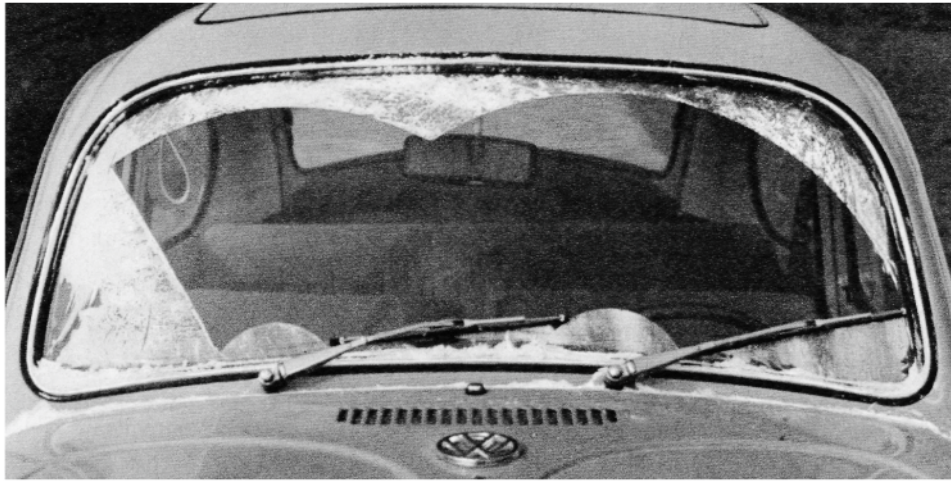
Scheibenwischerfeld mit einer relativ großen ungewischten Fläche auf der Beifahrerseite. Wascherdüse exponiert, staub- und frostgefährdet.
