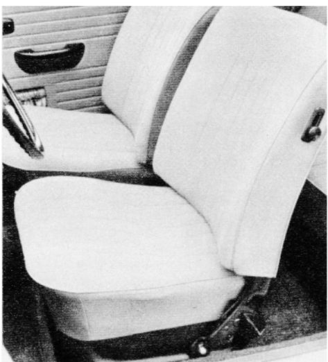
Bezugsstoff sehr angenehm auch bei warmem Wetter, jedoch zog er im Dauertest recht früh Falten.
