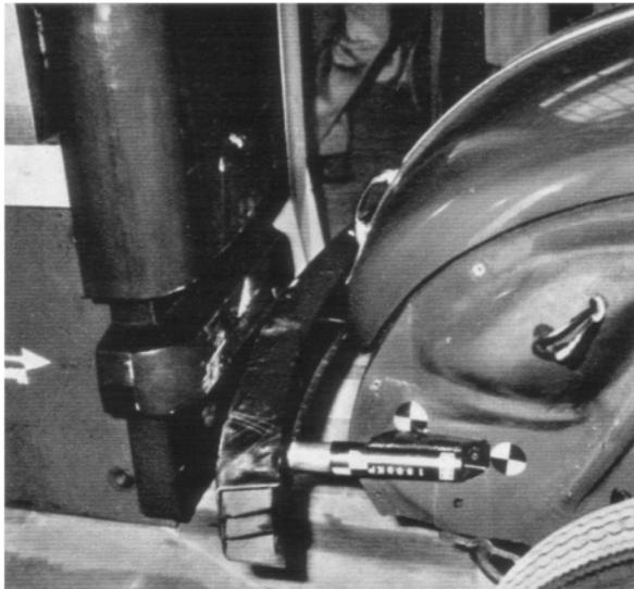
**Das neue Sicherheits-Wissen** wird, auch wenn die Entwicklung nicht den Weg zum sehr teuren Sicherheitsauto nehmen sollte, zweifellos in die Serienfertigung einziehen. Hier ein erstes, noch im Versuch befindliches Beispiel: ein Stoßabsorber an einem Käfer. Der Wagen übersteht Frontalkollisionen bis 10 km/h ohne jede Beschädigung.
