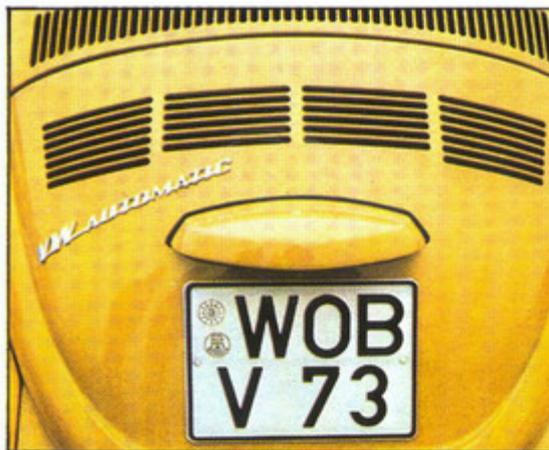
Äußeres Kennzeichen der 72er-Käfer sind die vier Kühlluft-Öffnungen in der Motorhaube
