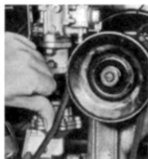
Prüfung der Keilriemen-spannung.
