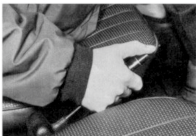
Diese Handbremse hat einen viel zu großen Hebelweg, sie muß nachgestellt werden.
