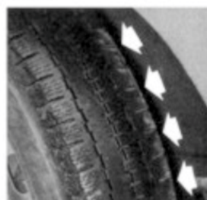
Stark abgefahrene innere Reifenschulter.
