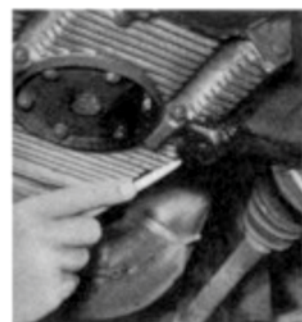
Sichtbarer Ölverlust an Motor und Getriebe.
