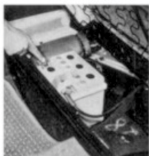
Batterie-Säurestand und Pol-Oxydation beachten.
