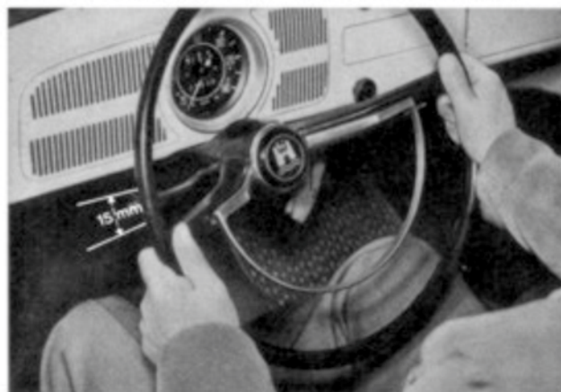
Die Räder dürfen bei der Messung des Lenkungsspiels nicht eingeschlagen werden. Messung am Lenkradkranz.
