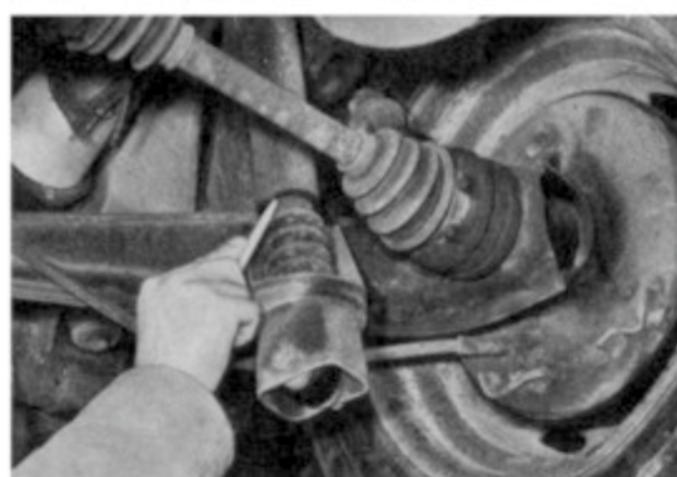
Stoßdämpfer an der Hinterachse eines VW 1600. Leichte Ölspuren erkennbar, noch unbedeutend.
