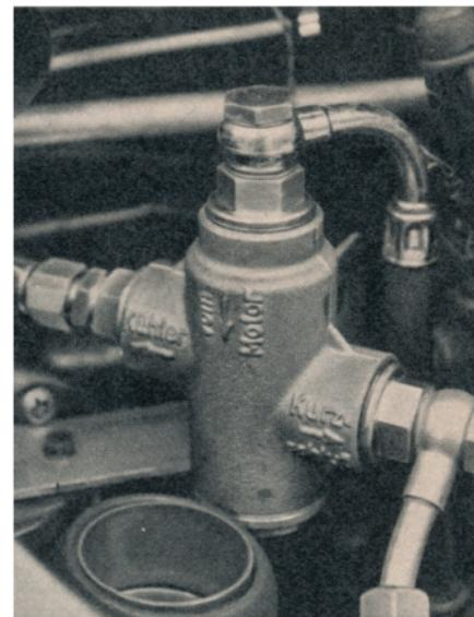
Dank des großdimensionierten Frontkühlers (links) wartet die Riechert-Maschine mit ausgesprochen zivilen Öltemperaturen auf. Der im Motorraum installierte Ölthermostat (oben) öffnet bei 80° C den Zufluß zum Kühler.
