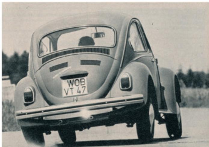
Während die alte Pendelachse den 1200 schon bei zivilen Geschwindigkeiten kräftig übersteuern läßt (oben) und auch die Ausgleichsfeder des 1300 in diesem Punkt nur wenig Besserung bringt (Mitte), sorgt die Doppelgelenkachse des 1302 für ein über weite Bereiche unproblematisches Kurvenverhalten (unten).
