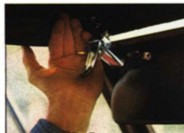
**3** Auch für Frauen noch zumutbar ist der Kraftaufwand, der für die vordere Dachverriegelung nötig ist. Die Haube wird mit einem Haltegriff nach unten gedrückt und mit Spannhaken verschlossen
