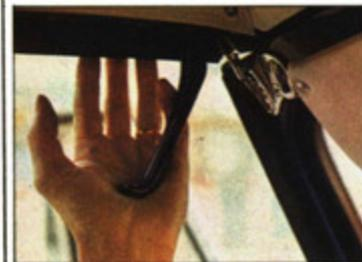
**3** Ist das Dach vorn in der Führung eingerastet, lassen sich die Spannhaken mit großen Hebeln ziemlich leicht bedienen. Von Beifahrern werden diese Hebel oft als Haltegriffe mißverstanden
