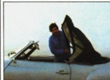
**1** Weitaus kompakter als bei Fiat und Peugeot ist das Karmann-Verdeck. In geöffnetem Zustand wird es von einer kleinen Schutzplane abgedeckt. Das Zuklappen geht leicht. Komplizierte Handgriffe sind nicht nötig
