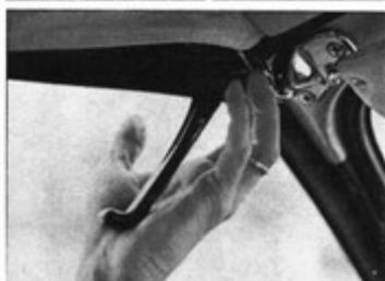
**3** Um das Dach dann endgültig zu verriegeln, benutzt man wie im Ghia lange Spannhebel. Beim Käfer werden sie kaum als Haltegriffe mißverstanden: Sie liegen zu weit abseits
