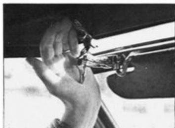
**3** Sollte die Armkraft doch einmal nicht ganz ausreichen, das Dach einrasten zu lassen, dann sorgen die seitlichen Spanner mit langen Hebeln dafür, daß man bei Regen schnell im Trockenen sitzt
