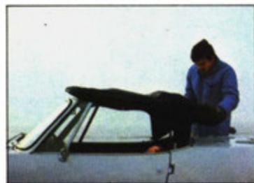
**2** Das Ausklappen des Verdecks geht leicht. Vor dem Schließen wird der hintere Dachabschluß mit Haken an der Karosserie verankert. Fingerübungen erfordern nur die seitlichen Befestigungen
