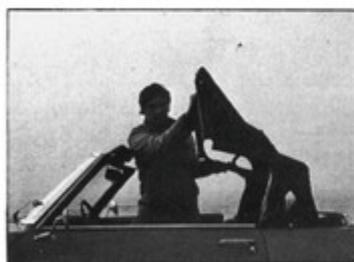
**1** Das Stoff-Verdeck des Peugeot 304 Cabrio läßt sich leicht aus seiner Ruhelage hochklappen. Klettenverschlüsse und ein paar Druckknöpfe dichten die Ränder an den Dachkanten und die hinteren Seitenteile ab
