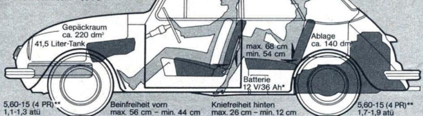
5,60-15 (4 PR)\*\*    1,1-1,3 atü    Beinfreiheit vorn max. 56 cm – min. 44 cm    Kniefreiheit hinten max. 26 cm – min. 12 cm    5,60-15 (4 PR)\*\*    1,7-1,9 atü
