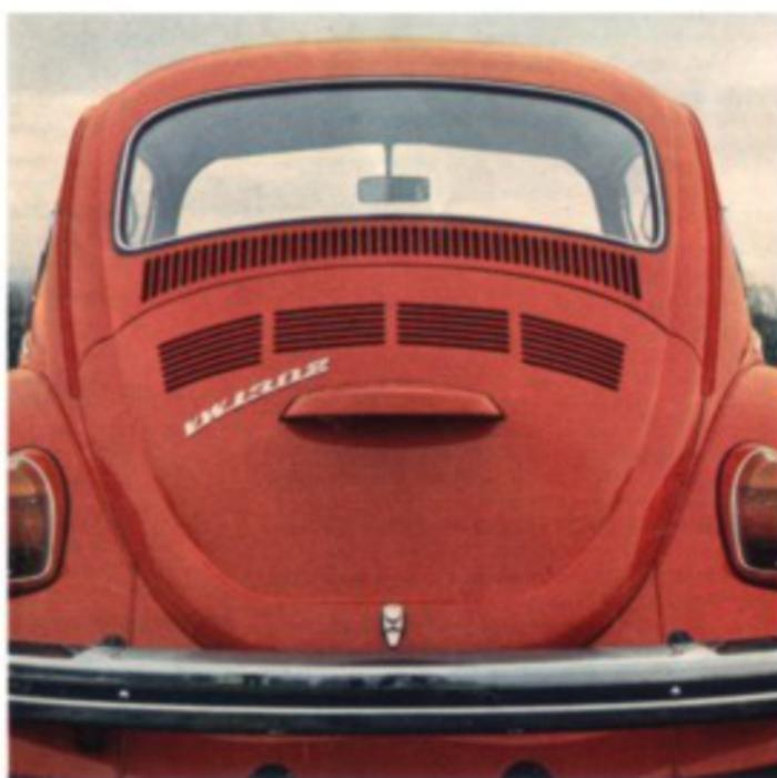
Das Rückfenster des Käfers ist nochmals um ein Stück gewachsen, und die Anzahl der Kühlluftschlitze in der Motorhaube ist angestiegen.
