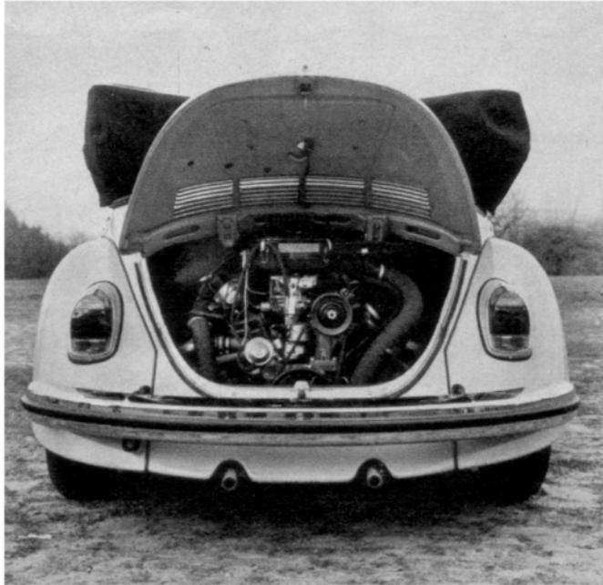
Das VW-Cabriolet wird nur mit dem 50-PS-Motor geliefert. Da in der Karosserie die Lüftungsschlitze für die Motor-Ansaugluft fehlen, hat die Motorhaube einige Luftschlitze mehr.
